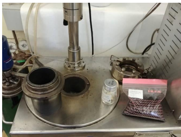
Obrázek 3: Laboratorní reaktor pro destrukční zkoušky
